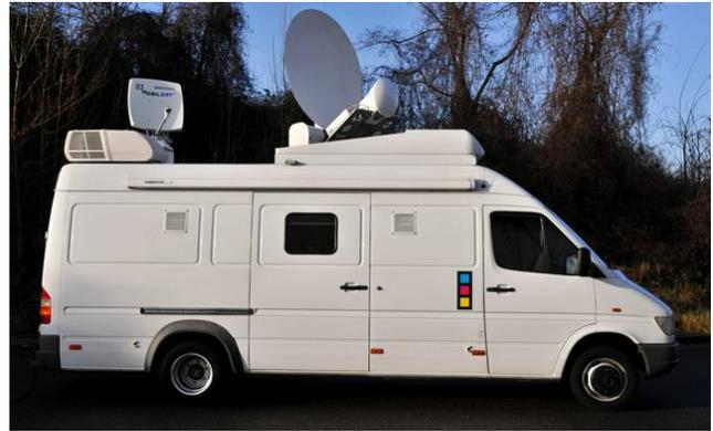
Ci-dessus, sur l'image de gauche on ne voit qu'une antenne de transmission, alors que sur l'image de droite on voit une antenne de transmission ainsi qu'une petite antenne de réception ordinaire. Le type d'antenne en losange du SNG de BFM est appelé antenne géorgienne.
